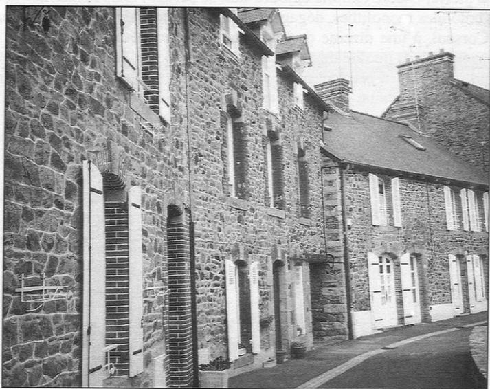
Figure 4. – Aspect caractéristique de l'habitat à Lamballe. Élévations en moellons d'orthogneiss ; entourages des ouvertures en briques rouges (près des haras).
