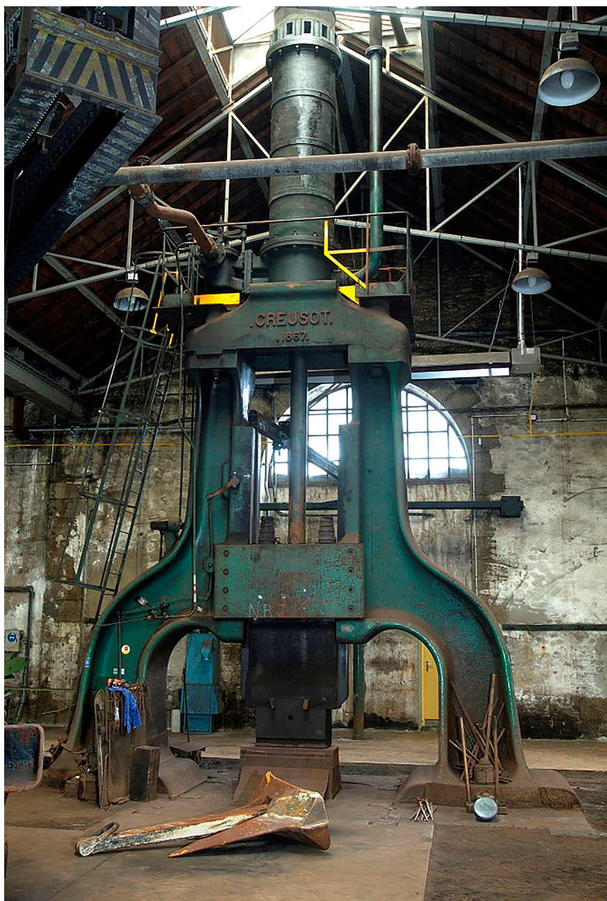
Figure 2 – Intérieur des Forges de Pontaniou, vue du marteau-pilon de 1867 (© DRAC)
